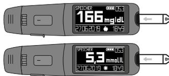
Считайте результат измерения. Для правильного считывания результата еще раз убедитесь, что символ подчеркивания находится под результатом измерения; если это не так, поверните прибор на 180°. Разъяснения к результатам измерений и описание возможных действий см. в разделе «5.6 Интерпретация результатов измерения содержания сахара в крови», стр. 26. При сообщении об ошибке см. раздел 8 «Что делать при возникновении каких-либо проблем?», стр. 35.
