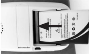
3. Vuelva a deslizar la tapa del compartimento de la batería situado en la parte trasera de la unidad para padres hasta que note y oiga cómo encaja.
