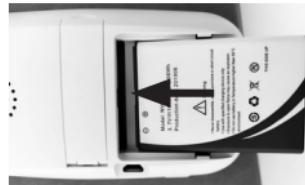
3. Zamknąć osłonę komory baterii na tylnej stronie jednostki rodziców, aż nastąpi słyszalne i wyczuwalne zatrzaśnięcie.
